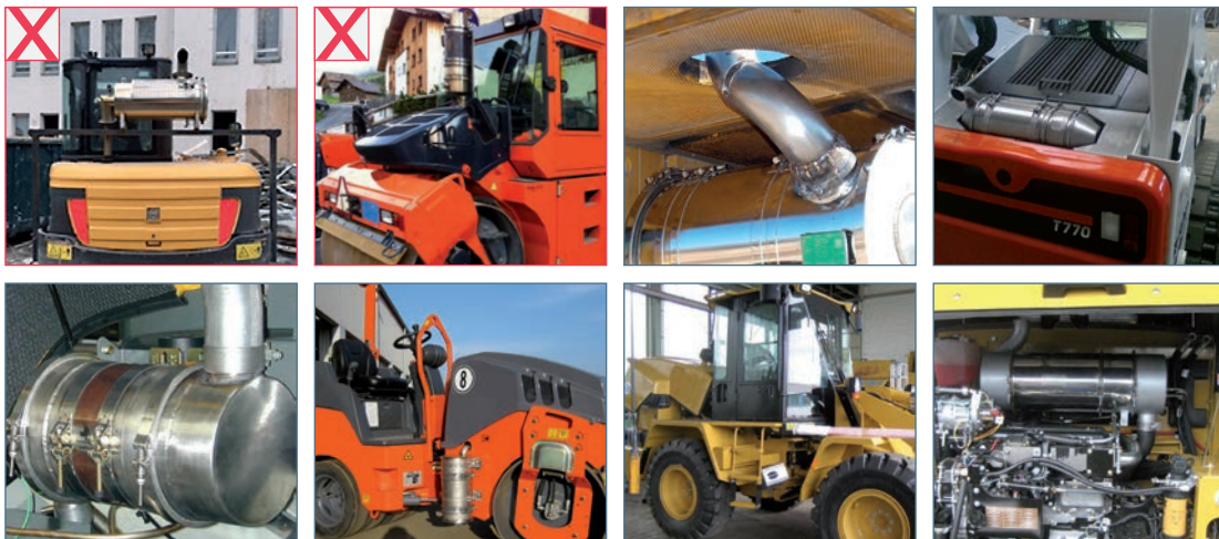
Foto 1 und 2 zeigen nachgerüstete Dieselpartikelfilter, die das Fahrersichtfeld einschränken. Sinnvolle Lösungen zeigen die nachfolgenden Abbildungen.
